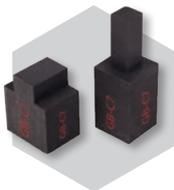
Nós fornecemos nossos eletrodos de cogumelo individualmente, de acordo com seus desejos. Os eixos são padrão 15 vezes 15 mm, 25 vezes 25 mm e 30 vezes 30 mm - adequado para todos os sistemas de suporte comuns. Todos os lados dos eletrodos do eixo são fresados, o sulco (20,00) é paralelo ao plano do solo. A tolerância é de 0/-0,5 mm.
